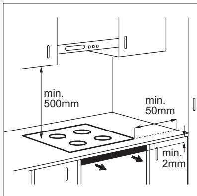
Dopo aver montato il piano di cottura, sigillare lo spazio rimanente tra il vetroceramica e il piano di lavoro con del silicone. Assicurarsi che il silicone non passi al di sotto del vetroceramica.
